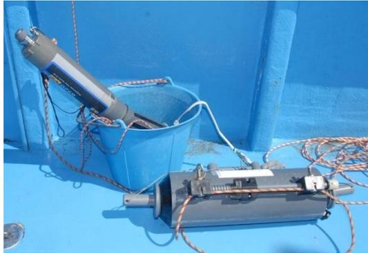
*Matériel de prélèvement utilisé dans le cadre d'une étude de la qualité des eaux : bouteille Niskin et sonde multi paramètre.*
