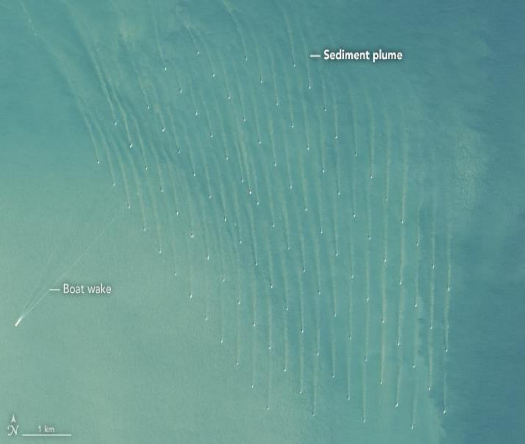
**Panaches (sediment plumes) de sédiments créés par les éoliennes et les courants de marées sur le site de la centrale en mer de Thanet en Angleterre . Photo satellite prise par la NASA.**
