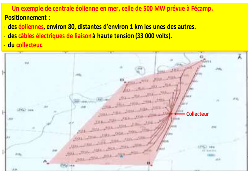
Figure 8 Plan d'implantation de la centrale éolienne en mer prévu à Fécamp
