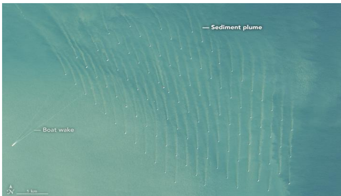
Figure 1: Panaches (sediment plumes) de sédiments créés par les éoliennes et les courants de marées sur le site de la centrale éolienne en mer de Thanet en Angleterre. Photo satellite prise par la NASA. Le même phénomène est à attendre au large d'Oléron, modifiant ainsi le transit des sédiments, mais aussi l'habitat des organismes marins.
